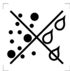
Bild 1 – Lampe, nicht geeignet für den Einsatz in feuchter Umgebung
