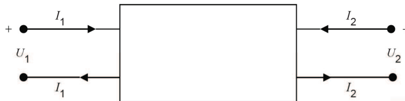
Bild 1 – Vereinbarungen über Vorzeichen in Stromkreisen
