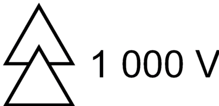
Bild 1 – Angabe der elektrischen Arbeitsgrenze neben dem Bildzeichen Doppeldreieck (IEC 60417-5216:2002-10)
