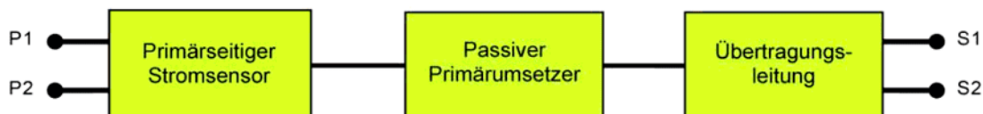
Bild 1001 – Allgemeines Blockschaltbild für einen einphasigen passiven Kleinsignal-Stromwandler
