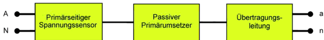
Bild 1101 – Allgemeines Blockschaltbild für einen einphasigen passiven Kleinsignal-Spannungswandler
