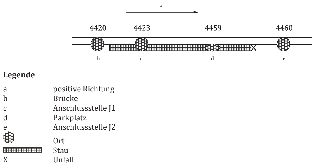
Bild 3 — Raststätte an nur einer Fahrbahn
