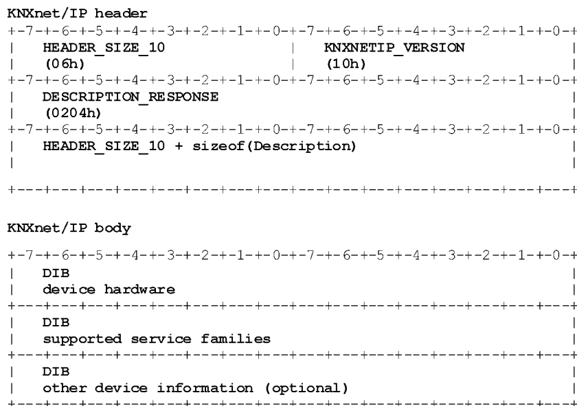
Bild 29 — DESCRIPTION_RESPONSE-Frame im Binärformat
