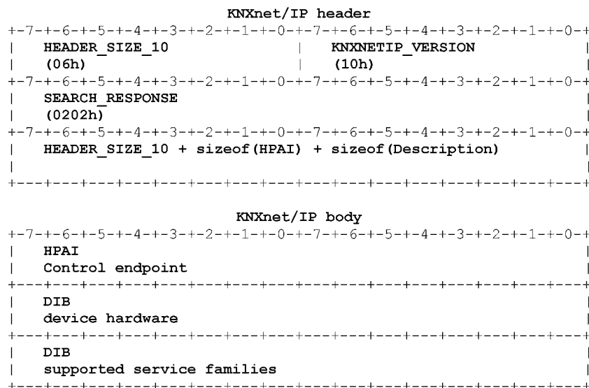
Bild 20 — SEARCH_RESPONSE-Frame im Binärformat:
