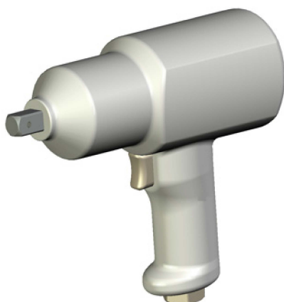
Bild 1 — Schlagschrauber, Mutterndreher mit Impulsantrieb, jeweils mit Pistolengriff
