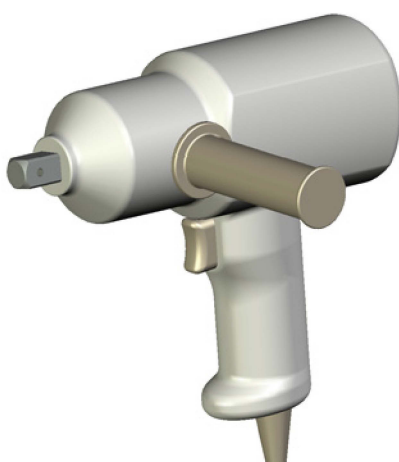
Bild 2 — Schlagschrauber, Mutterndreher mit Impulsantrieb, jeweils mit Pistolengriff und Zusatzgriff
