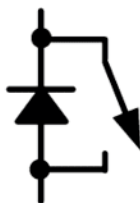
Bild 11 – Symbol eines Ausschalt-Halbleiterbauelements und der zugehörigen Freilaufdiode
