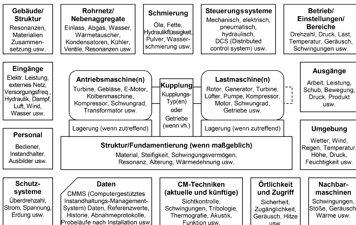
Bild 2 — Systemfaktoren mit Einfluss auf die Zustandsüberwachung
