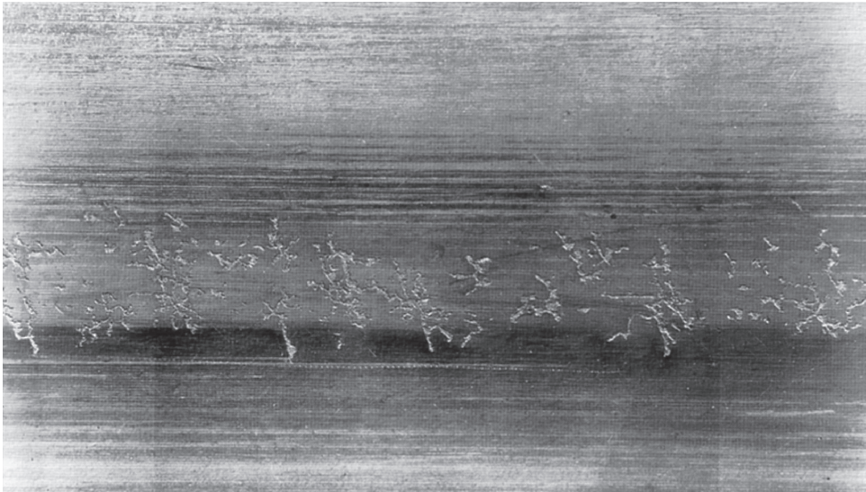
Bild 8— Risse in der Auflage eines mehrschichtigen Lagers in einem schmalen Bereich mit hoher Belastung (Werkstoff: Stahl/Bleibronze/galvanisierte Auflage)
