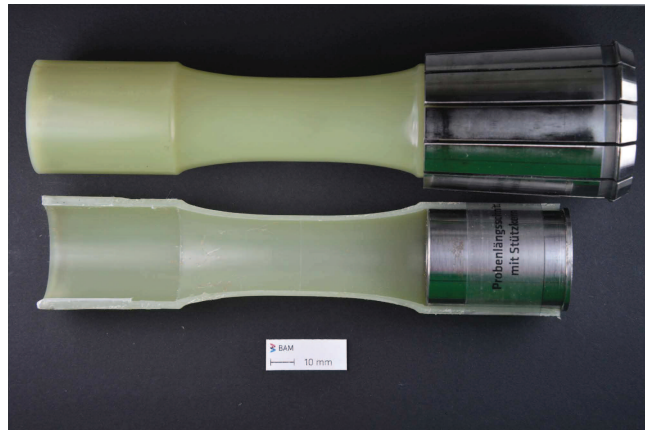
Bild 2 — Prüfkörper A mit Spannzange und aufgeschnitten mit Innenstützkern
