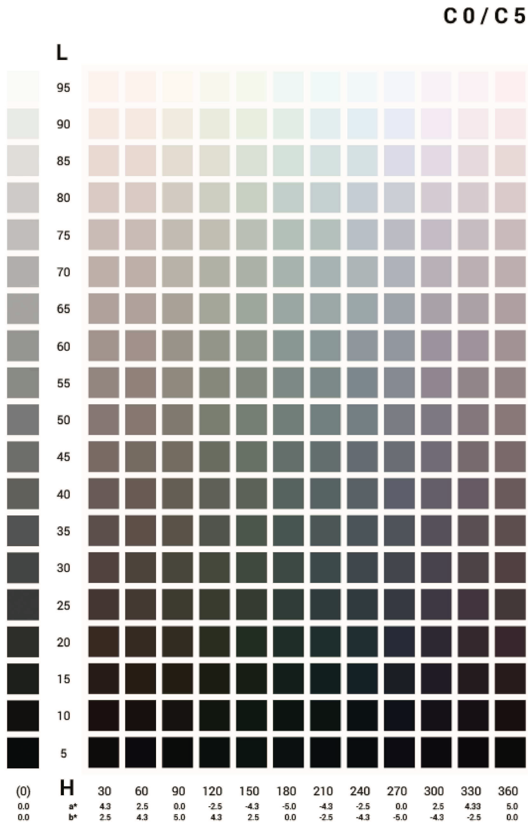
Bild 3 — Unterteilung der Grauseite
