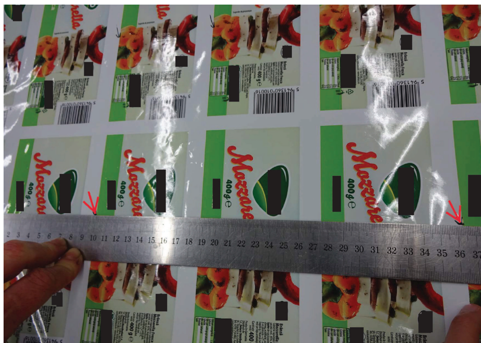
Bild 2 — Rapport messen am Druckbild ohne Steuermarke
