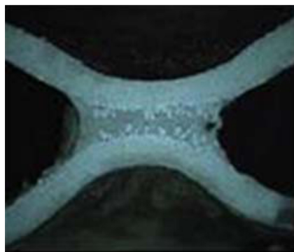
Bild 3 — Beispiel eines erforderlichen metallurgischen Schnitts durch die Lötung eines Turbulatorpaares
