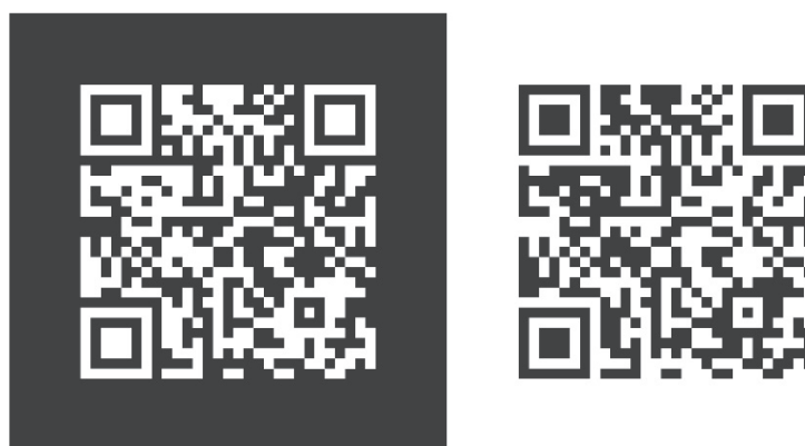
Bild 7 — Vergleich eines 2D-Codes als Negativ- und als normale Positiv-Abbildung
