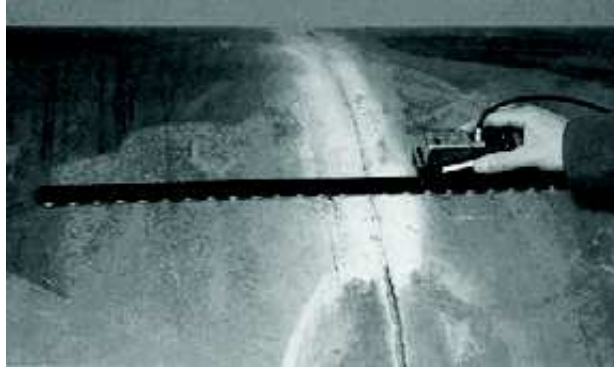
Bild 2 — Einfaches System mit einem Prüfkopf
