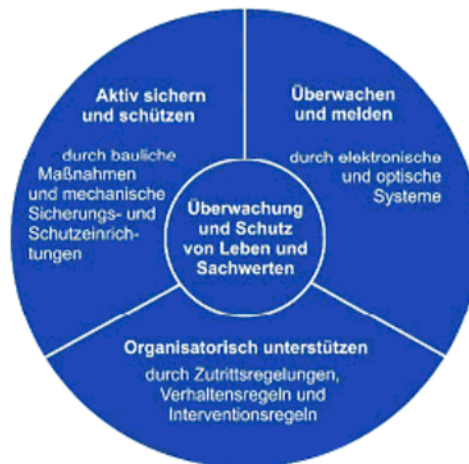
Bild 1 – Bestandteile eines Sicherungskonzeptes
