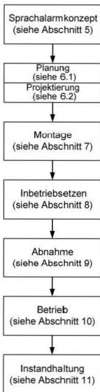
Bild 1 – Sprachalarmanlagen: Phasen für Aufbau und Betrieb
