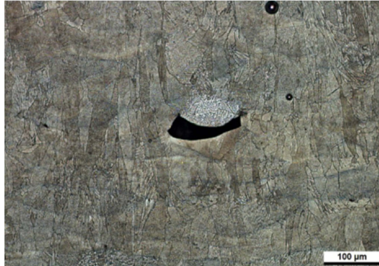
Bild 1 — Beispiel für Hohlräume, überwiegend durch fehlerhaften Lagenaufbau hervorgerufen (Laserstrahl-Pulverbettverfahren, Titan 6AlV4)
