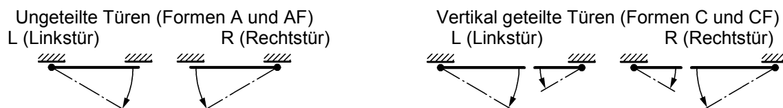
Bild 3 — Ungeteilte und geteilte Türen – rechts und links
