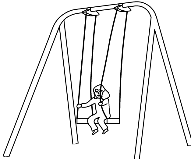
Bild 2 — Beispiel für eine Schaukel mit mehreren Drehachsen (Typ 2)
