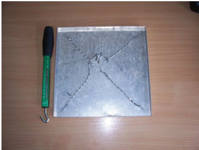
Bild 4 — Schale mit Ketten und mittigem Haken für das Wägen
