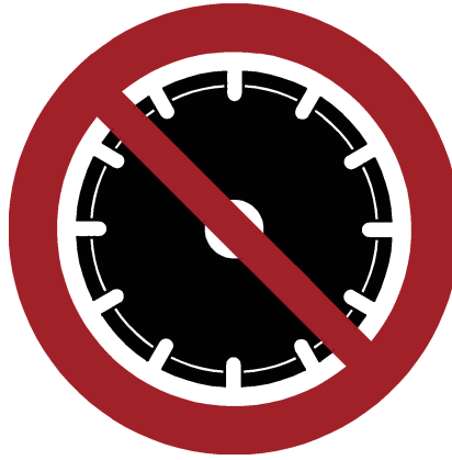
Bild 4 — "Nur Trennscheiben mit geschlossenem Rand verwenden"
