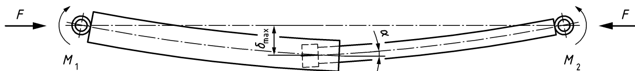
Bild 15 — Zylinder mit Endmomenten aus Achsreibungen und Winkelversatz
