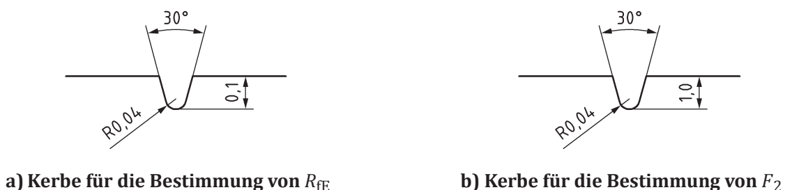
Bild 3 — Kerben von Dauerfestigkeitsproben
