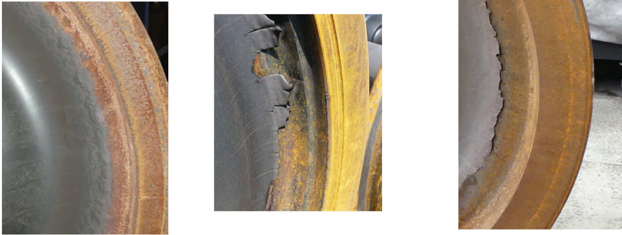
Bild 9 — Beispiele für thermische Überbeanspruchung im Übergangsbereich Radkranz/Radsteg
