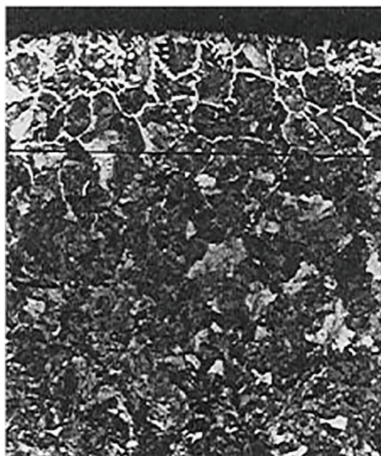
Bild 5 — Mikrogefügeaufnahme (100fache Vergrößerung) mit der für die Schienen-Verschleißoberfläche zugelassenen Entkohlungstiefe
