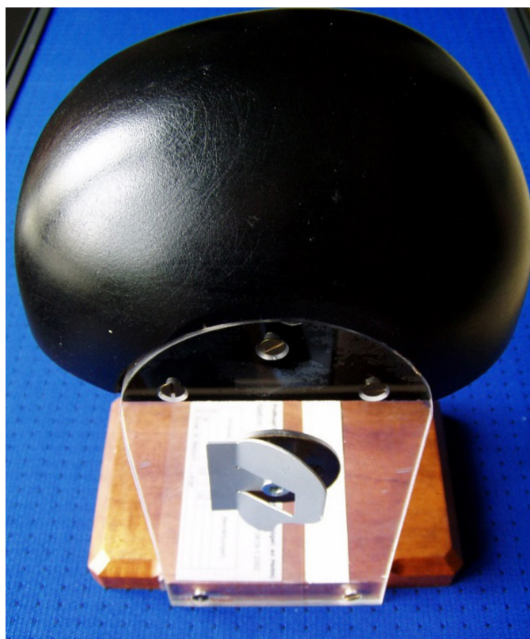
Bild 6 d) — Beispiel für einen am Prüfkopf angebrachten Ohrmuschel-Simulator nach Bild 6 a)
