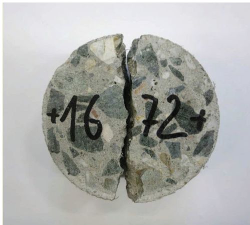
Bild 2 — Bruchmuster nach der Prüfung
