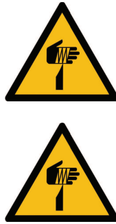
Bild 12 — Beispiel für ein Warnschild in Übereinstimmung mit EN ISO 7010:2020: W022 „Warnung vor spitzem Gegenstand“
