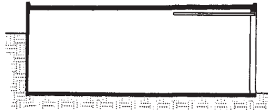
Bild 7 Beispiel für angeschüttete Garage
