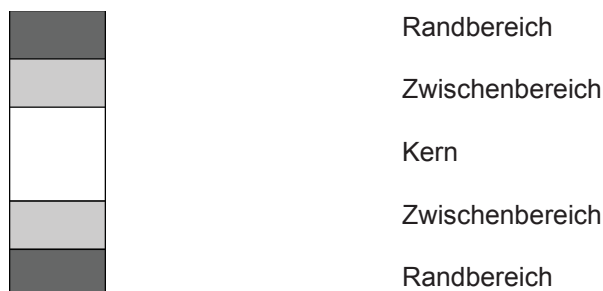
Bild 6 — Beispiel für einen Querschnittsaufbau bei kombiniertem Brettschichtholz
