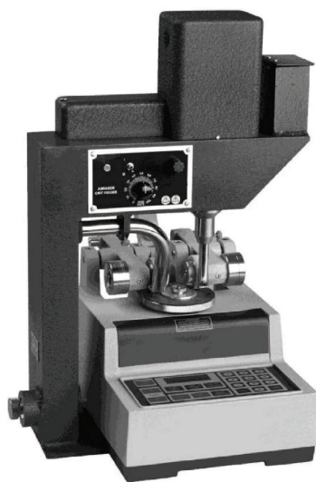
Bild D.2 — Beispiel für ein Taber-Abriebprüfgerät mit Schleifmittelzuführung
