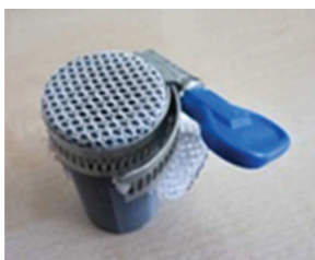
Bild 11 — Beispiel für die Aufnahmevorrichtung zur Prüfung der Maschenweite
