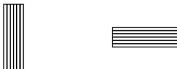
Bild 1 — Dicke und Breite eines Querschnittes von Furnierschichtholz
