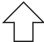
Bild 1 — Graphisches Symbol ISO 7000 - 1861 Angabe der vertikalen Ausrichtung
