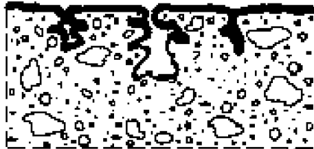
Bild 2 — Schematische Darstellung einer typischen Imprägnierung
