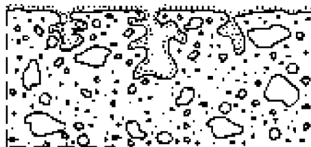
Bild 1 — Schematische Darstellung einer typischen hydrophobierenden Imprägnierung
