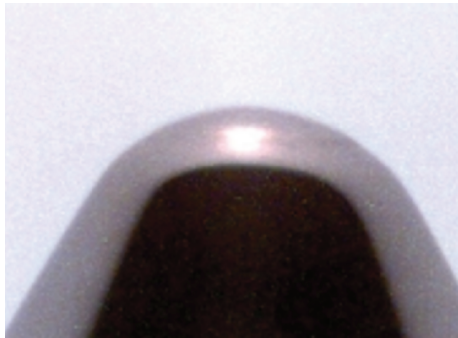
Bild 2 — Korrigierte Form der Kratzspitze
