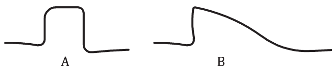
Bild 2 — Beispiel einer Signalform eines guten (A) und eines schlechten (B) Schwefelkohlenstofflösemittels, erhalten unter kryogenen Bedingungen
