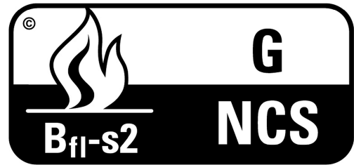
b) Befestigungsverfahren „verklebt“ und Substrattyp „nicht brennbar“
