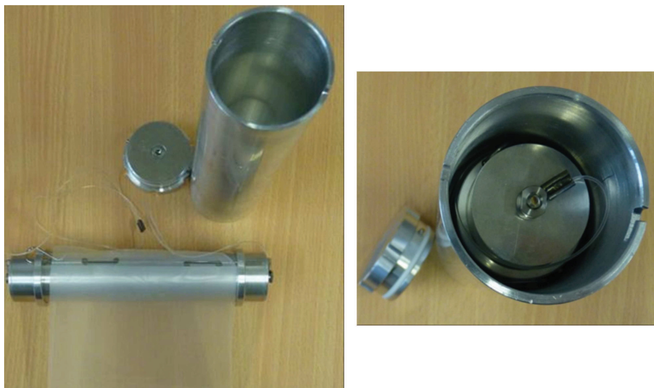
Bild 6 — Vormontiertes Hubschrauber-Probenahmegerät neben dem (links) und verpackt im Transportbehälter (rechts)
