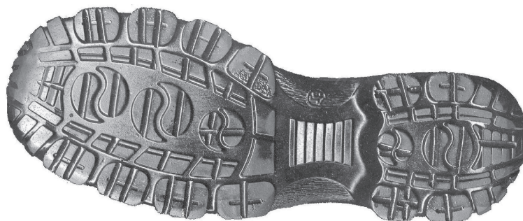
Bild B.2 — Profilierte Sohle des Prüfschuhs
