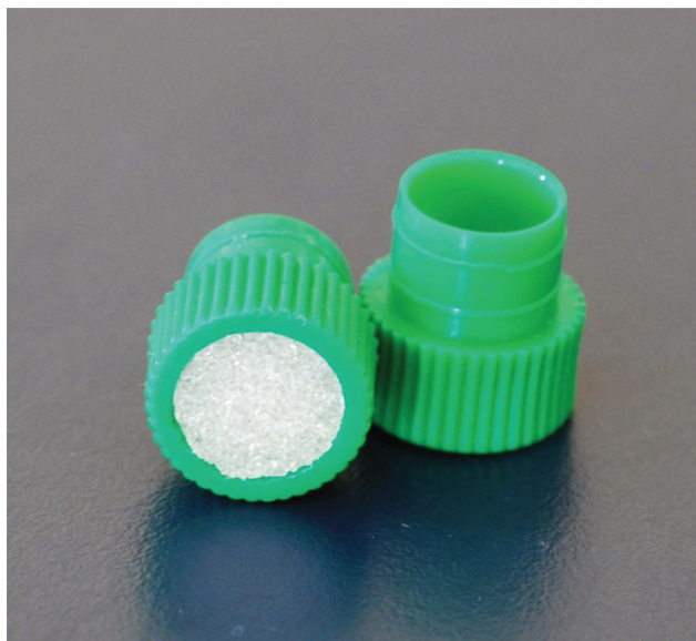
Bild A.5 — Schutzfilter (Glasfritte)
