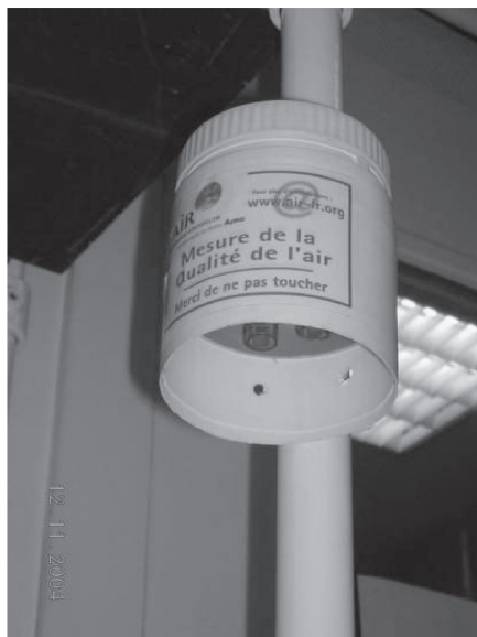
Bild A.3 — Sammler des Röhrchentyps mit zylindrischem Röhrchen im Schutzgehäuse
