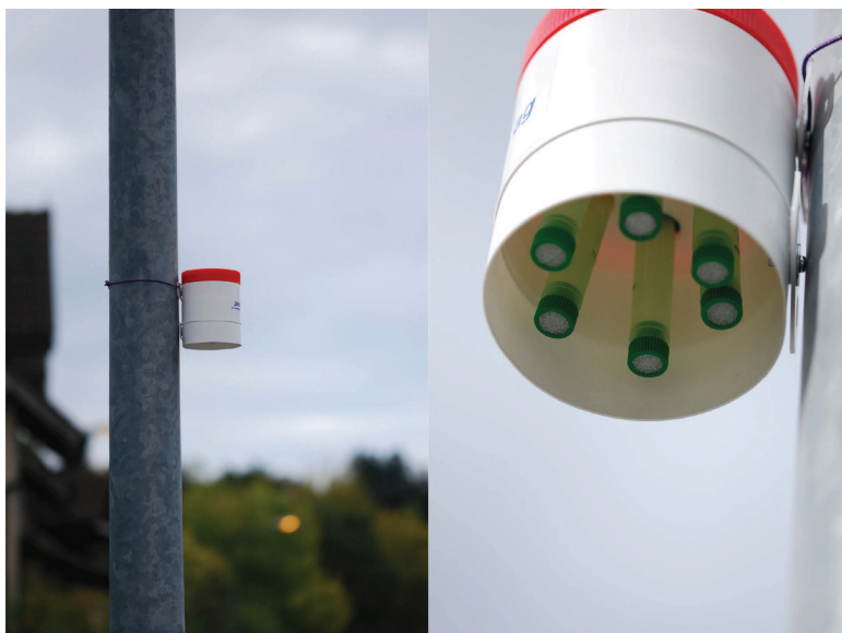
Bild A.6 — Schutzgehäuse für NO 2 -Sammler
