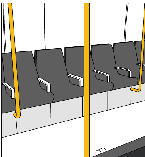
Bild 4 — Kontrast von Handläufen zum Hintergrund
