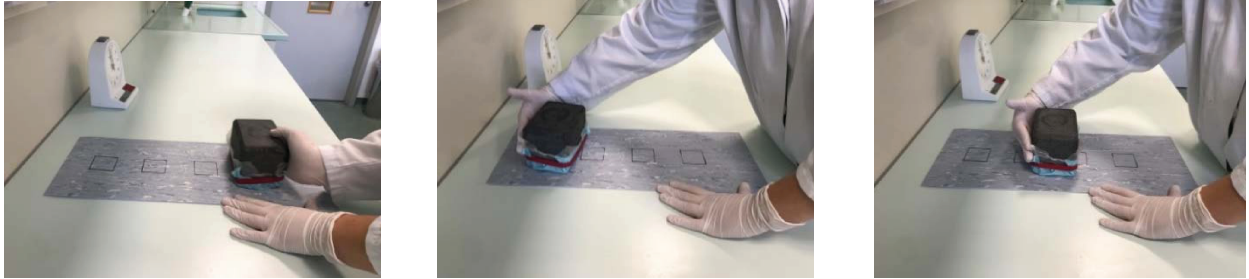
Bild 7 — Schieben des Einheitsgewichts von Hand über die Prüfflächen, ohne zusätzlichen Druck auszuüben
