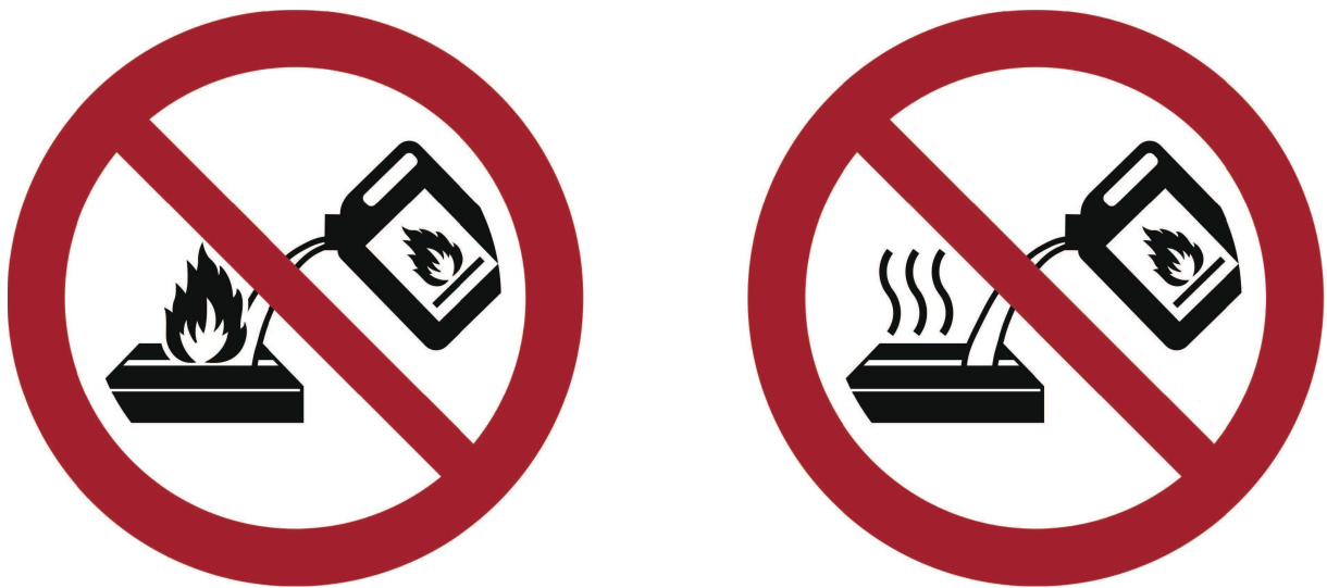
Bild 6 — Graphisches Symbol „Brennstoff nicht in die offene Flamme gießen. Brennstoff nicht in die heiße Brennkammer einfüllen“
