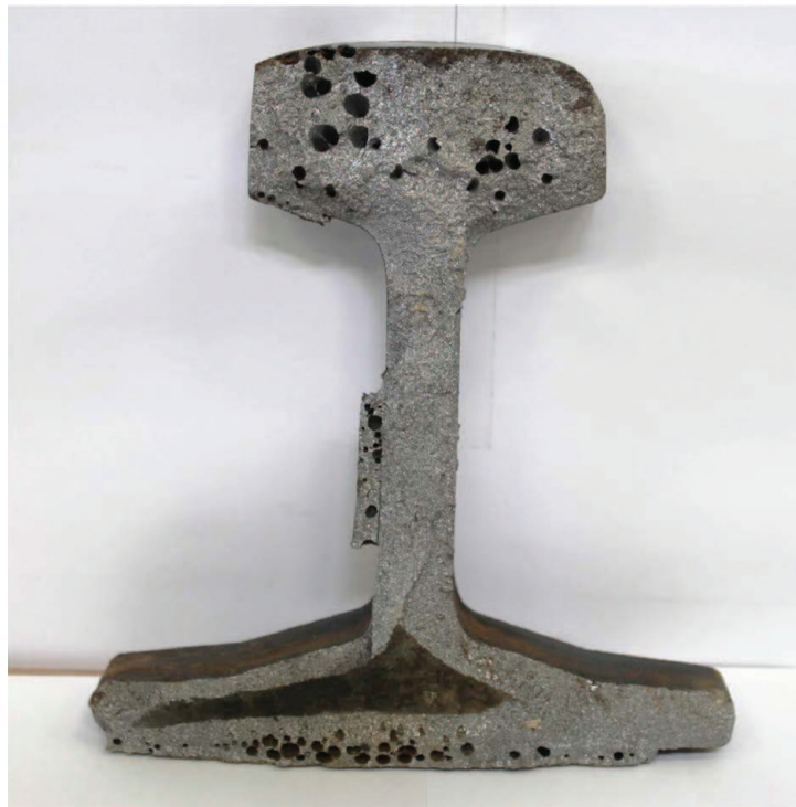
Bild 12 — Aluminothermische Schweißung mit Bindefehler am Schienenfuß und Porosität
