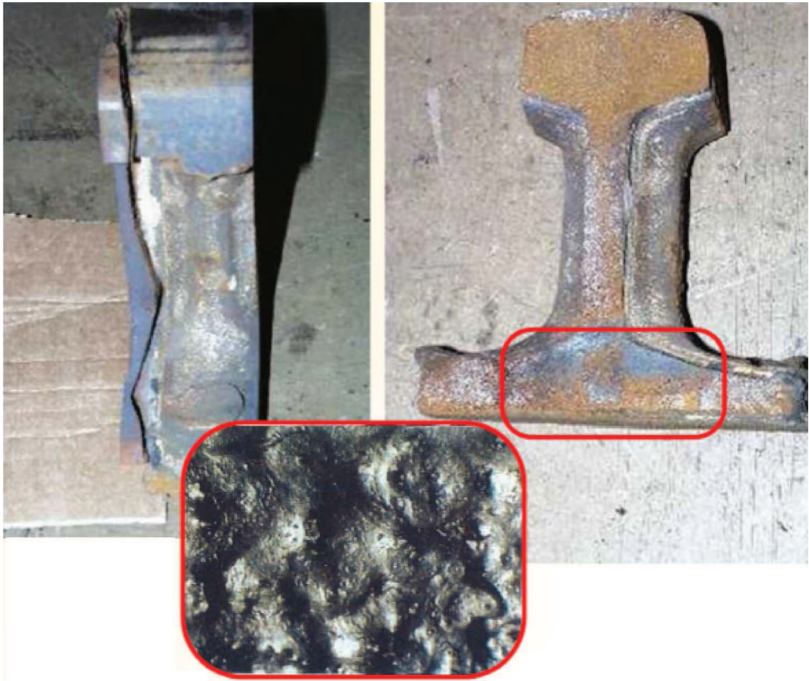
Bild 9 — Nichtmetallischer volumetrischer Einschluss (a)
