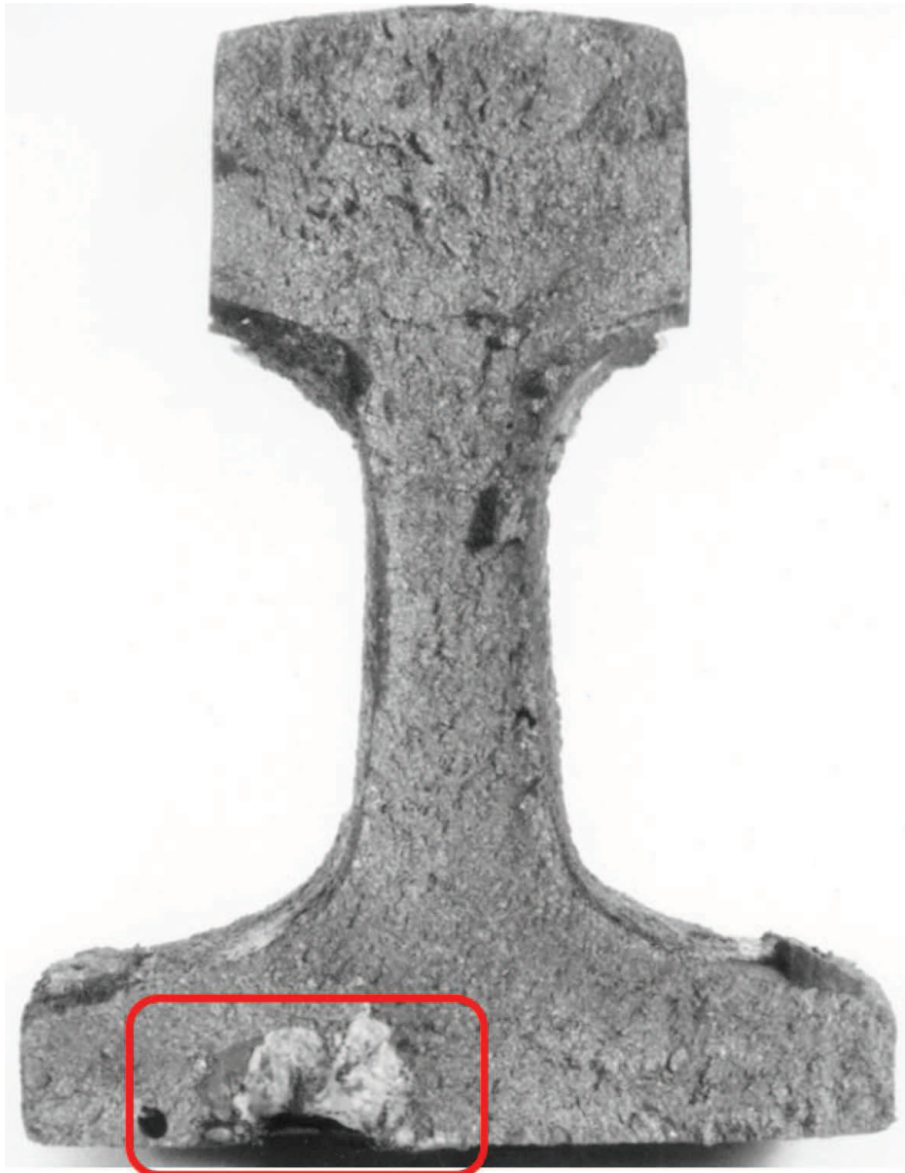
Bild 10 — Nichtmetallischer volumetrischer Einschluss (b)
