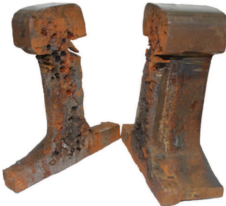
Bild 8 — Porosität an aluminothermischen Schweißungen
