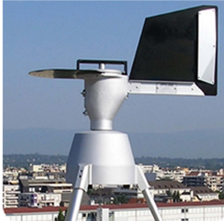
Bild 3b — Foto eines volumetrischen Probenehmers nach Hirst [Quelle: RNSA]
