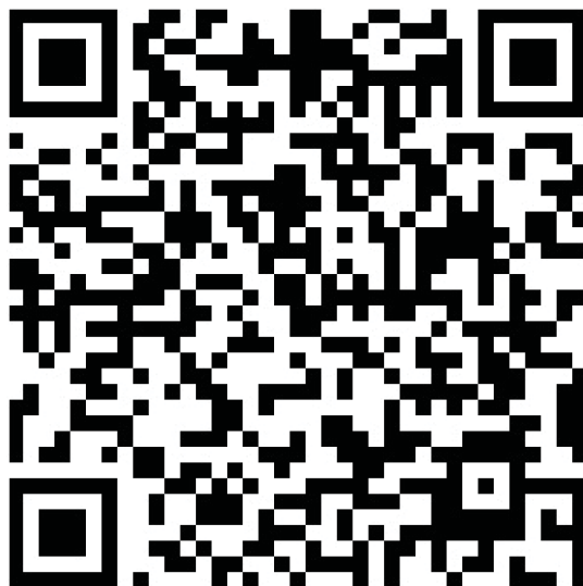
Bild 13 — QR-Code mit UID und Anwenderdaten mit ASC MH10-Datenbezeichnern, 35 × 35 Zellen, Größe 8,75 mm × 8,75 mm + Hellzone (X = 0,25 mm)
