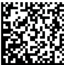
Bild 10 — DataMatrix mit UID und Anwenderdaten mit ASC MH10-Datenbezeichnern, 26 × 26 Zellen, Größe 6,5 mm × 6,5 mm + Ruhezone (X = 0,25 mm)
